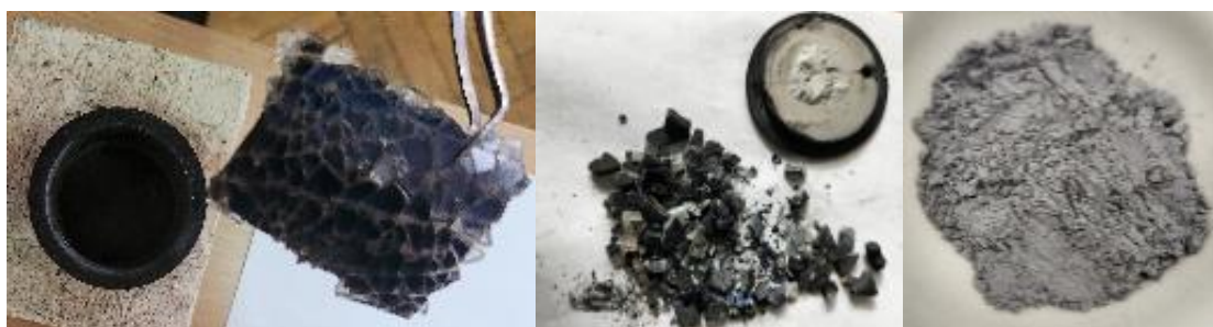
Рис. 2. Термическая обработка фрагмента фотоэлектрического модуля в электродуговом плазменном реакторе переменного тока
