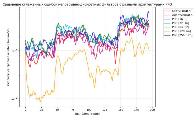
Рис. 1. Сравнение сглаженных ошибок RL-алгоритма (PPO) при разных архитектурах и классических вариантов фильтра Калмана
