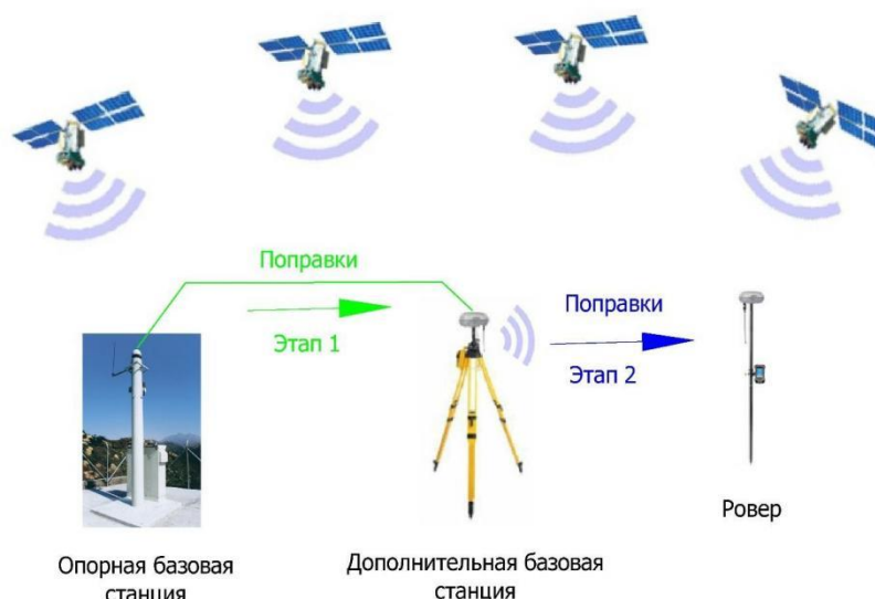
Рис. 1. Схема подключения и передачи данных с двумя базовыми станциями и ровером
